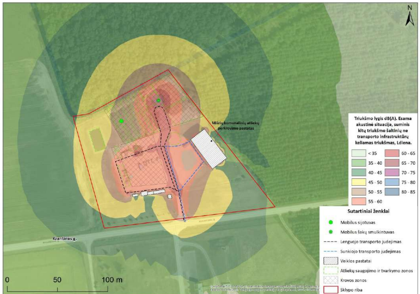
14 pav. Esamos akustinės situacijos triukšmo sklaida, suminis kitų triukšmo šaltinių (ne transporto infrastruktūrų) keliamas triukšmas, Ldiena
